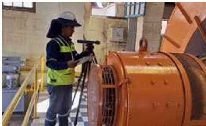
Estudios/Monitoreos Ruido Ocupacional (Plantas Hidroeléctricas Río Yura)
